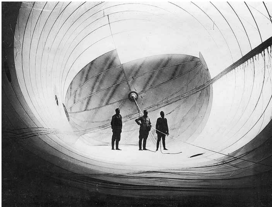
Ventillátorral felfújtt 98 M ballon köpenyének ellenőrzése (Kajon Árpád gyűjteményéből)
