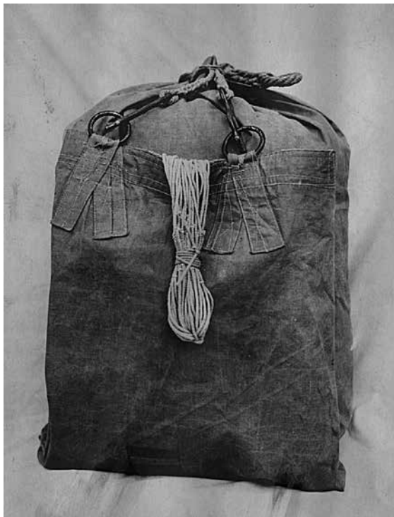
Brunner-rendszerű ejtőernyő a ballonkosár oldalára felerősíthető tartózsákban (HTM Fotóarchívum 102962/Fk)
