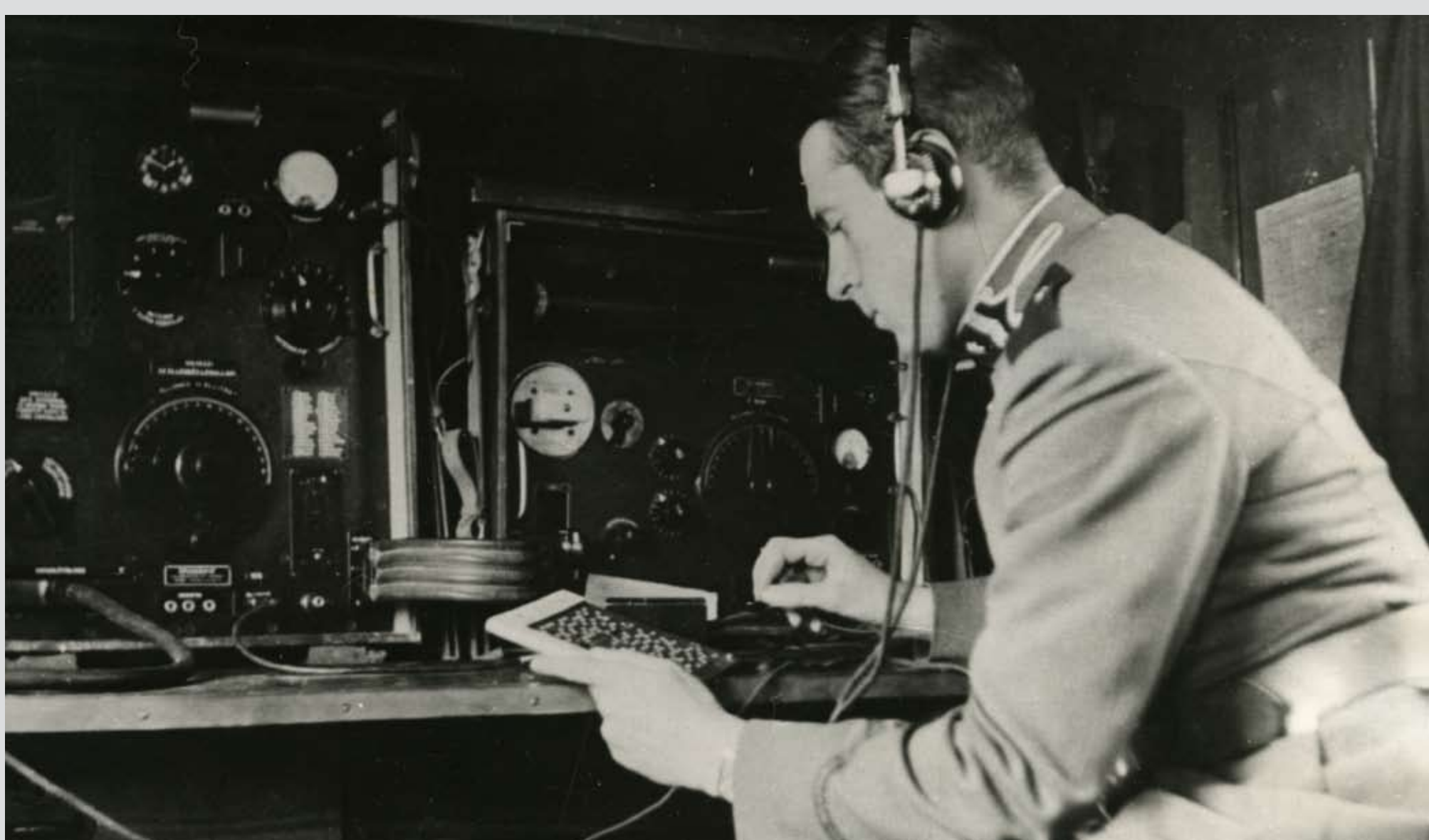
Telepített R-8 adó-vevő típusgépkocsi belseje, C-1 típusú rejtjelző eszközzel, táviró üzembn The interior of a deployed R-8 transceiver automobile with a C-1 encryption device,ú in telegraph mode
