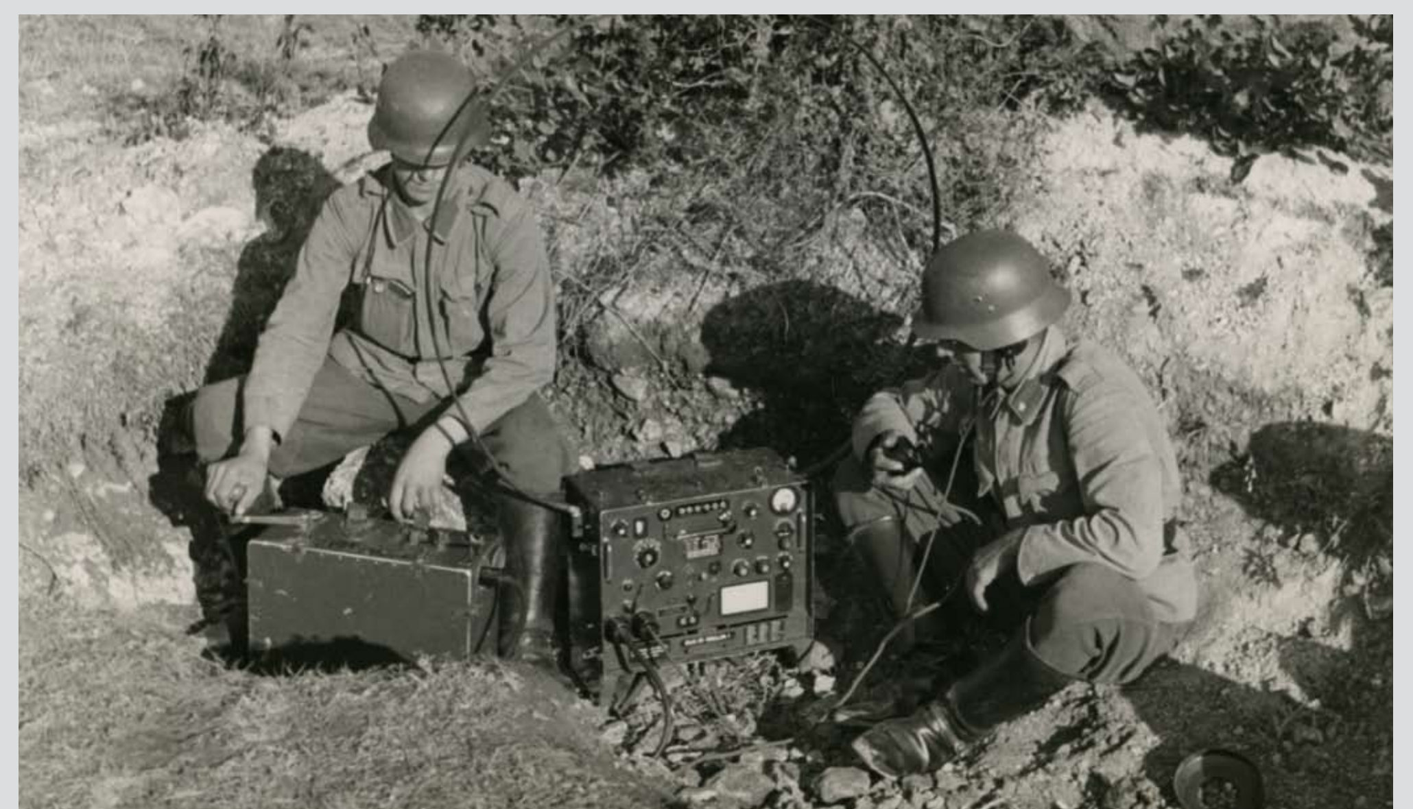
Telepített R-3 rádió távbeszélő üzembn. Hajmáskér, 1930-as évek vége Deployed R-3 radio in telephone mode. Hajmáskér, end of 1930s
