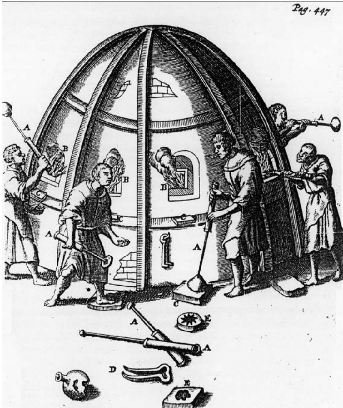
Üvegfüvő kemence munka közben 52
