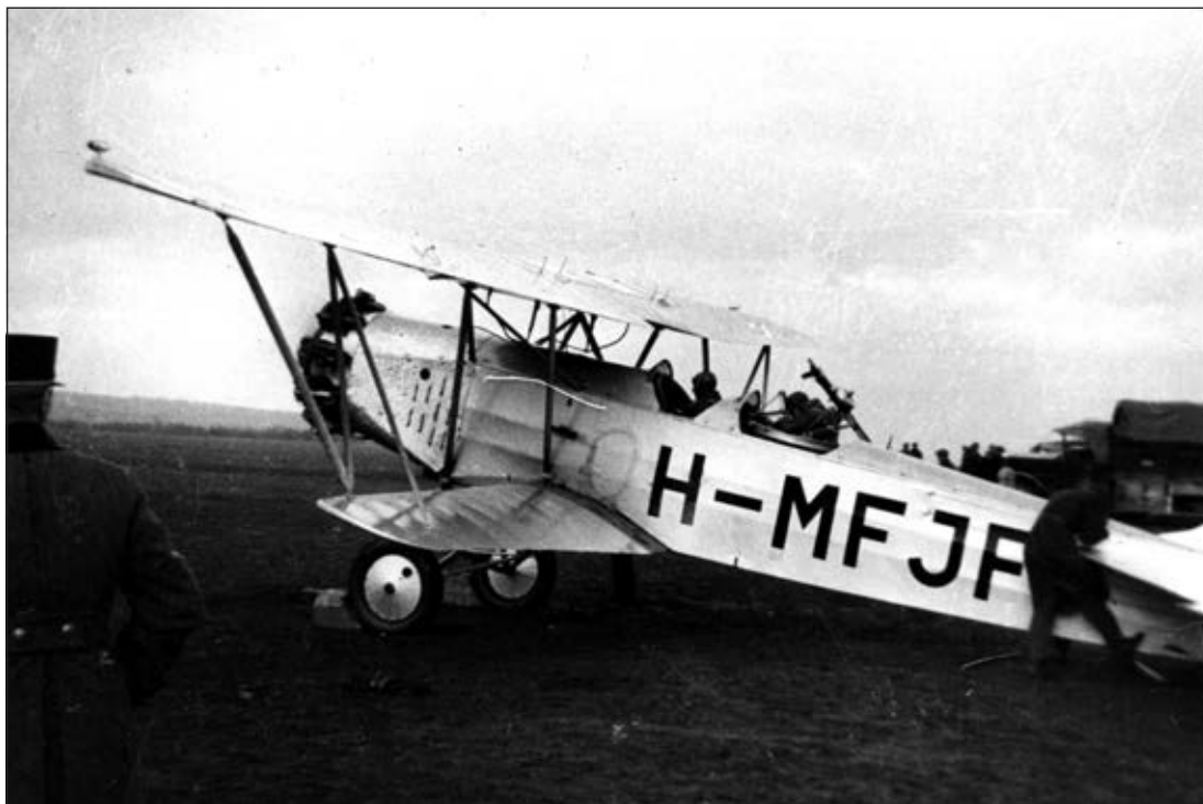
Fokker D. V. D. F. felderítő repülőgép Gebauer-géppuskával, Székesfehérvár-Sóstó, 1932.
