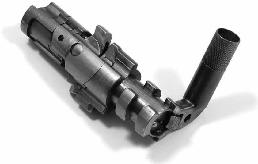
A Király/Lovász puska zárszerkezete (SHW SIG, SNr. 1454, a szerző felvétele)
