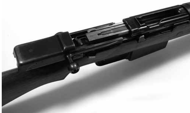
A KE-9 öntöltő puska hátrabúzott zárral (SHW SIG SNr. 1391, a szerző felvétele)
