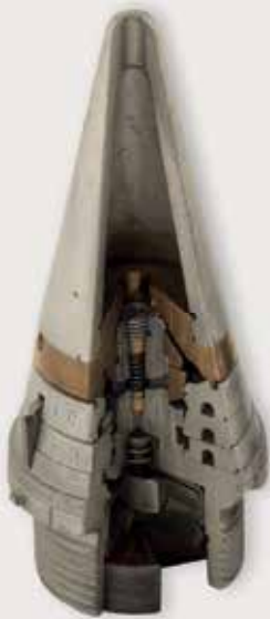
Magyar gyártású tüzérségi gyújtószerkezetek (1950 után)
